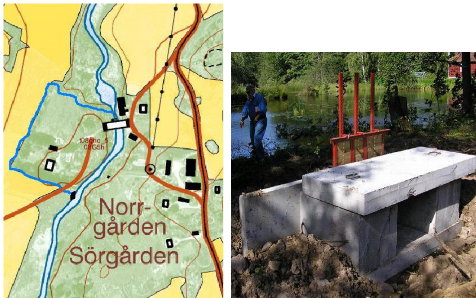
Figur 31. Skiss på karta över det befintliga dikets sträckning som kan fungera som omlöp. Fotot till höger visar exempel på ett utskov (källa: www.gis.lst.se , foto: P. Johansson).
